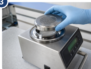
Remise en place du crible
